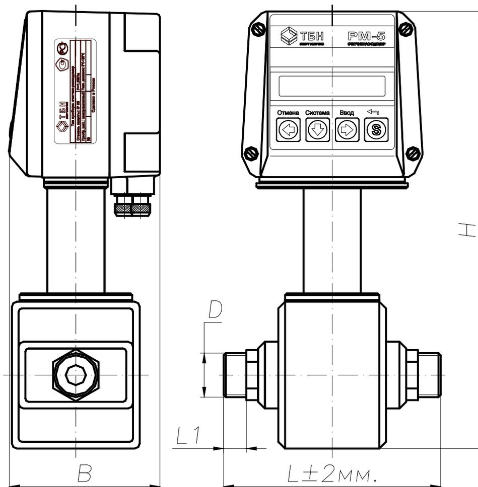
Рисунок В.2 —Резьбовое присоединение датчика расхода
