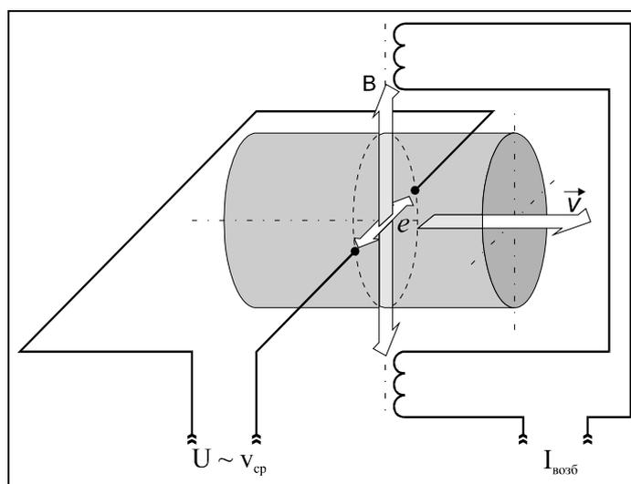
Рисунок 1 — Принцип работы электромагнитного первичного преобразователя (датчика) расхода
