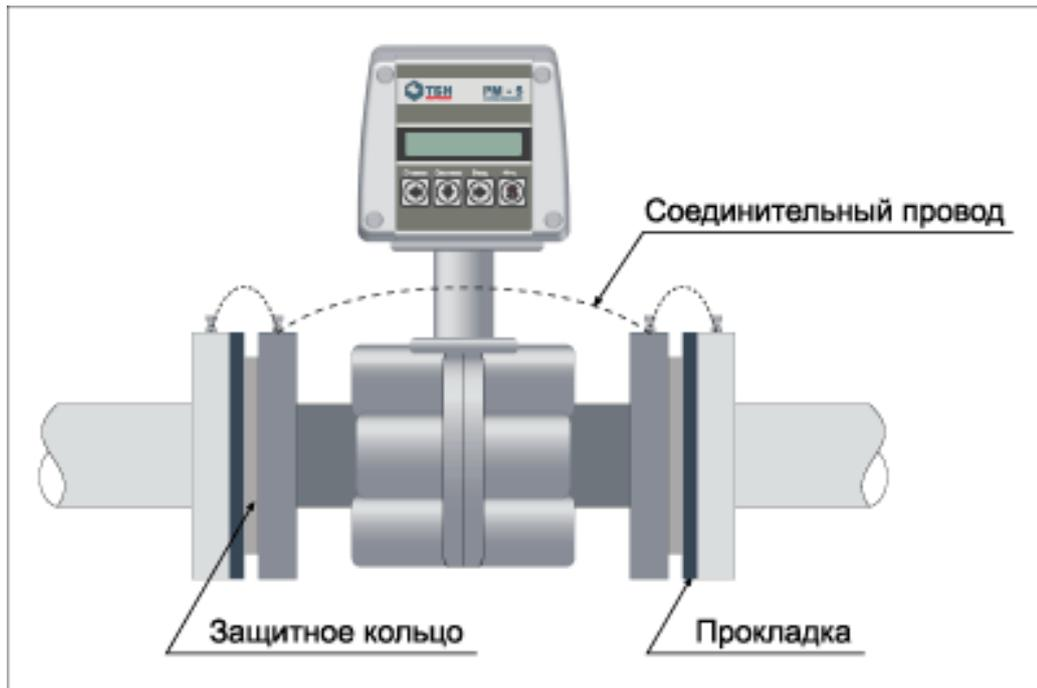
Рисунок 9 — Необходимые электрические соединения датчиков расхода
