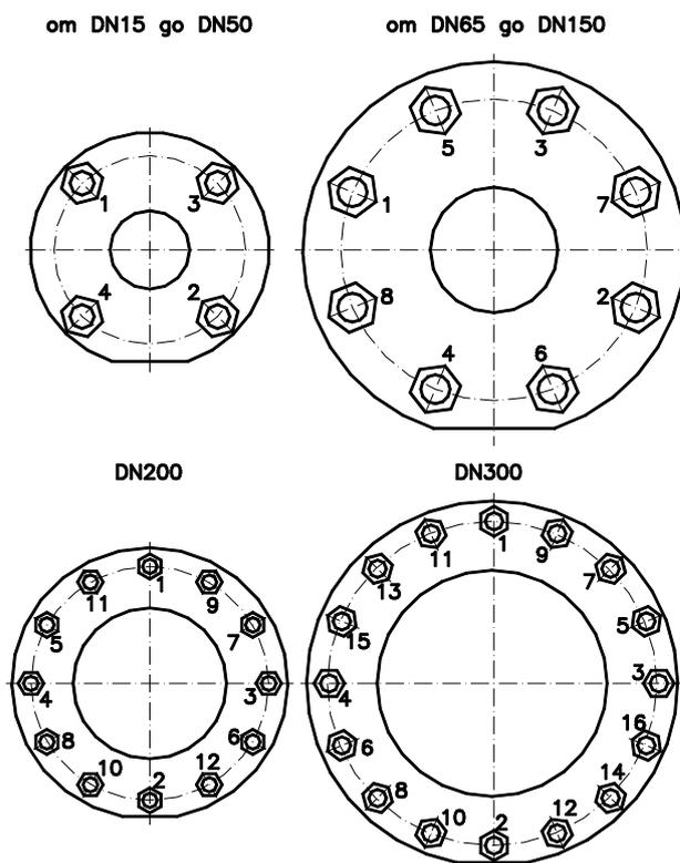
Рисунок 6 — Порядок затяжки гаек при установке преобразователя
