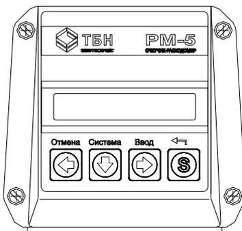
Рисунок 2 — Внешний вид электронного блока с вычислительным устройством
