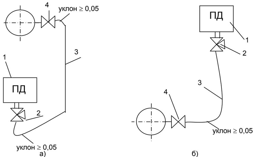
Рисунок 10 — Схемы присоединения датчиков давления на измерительном участке
