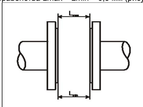
Рисунок 5 — Определение отклонения фланцев трубопровода от параллельности
