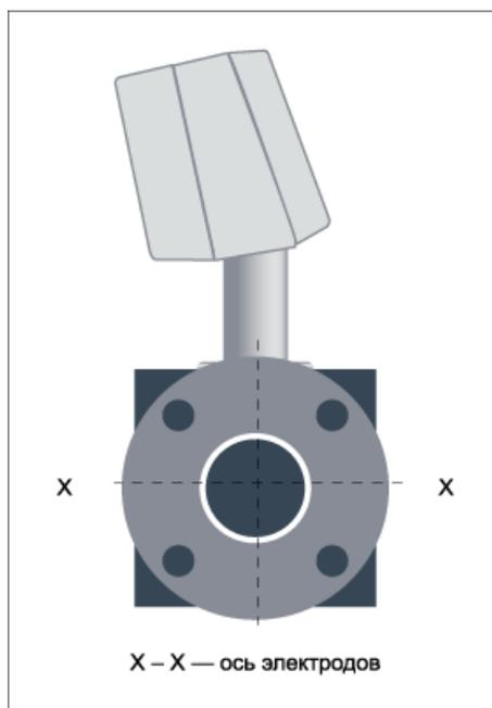
Рисунок 4 — Ориентация датчика расхода относительно оси электродов
