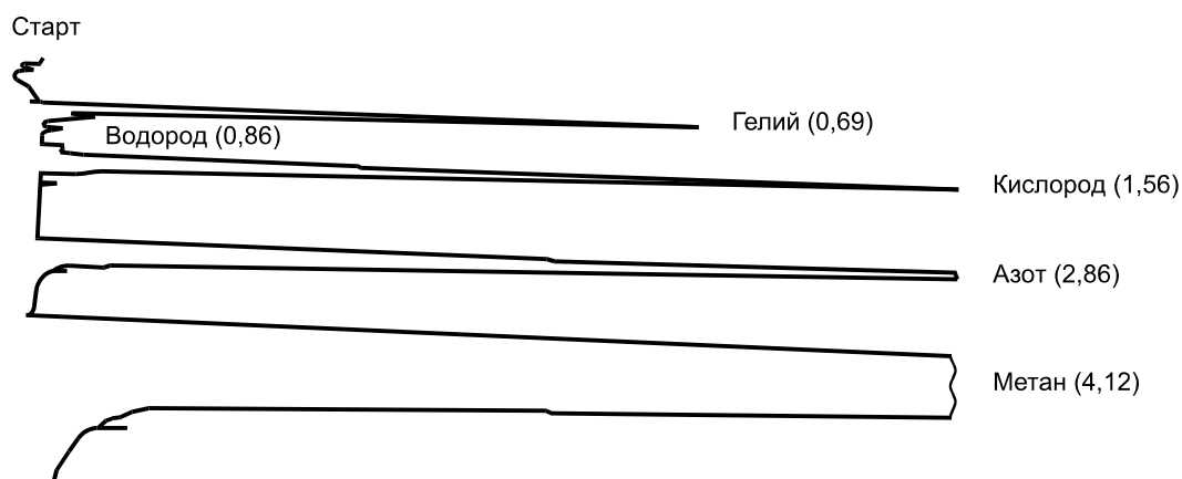
Рисунок А.1 — Типичная хроматограмма гелия, водорода, кислорода и азота на колонке с молекулярным ситом 13Х (указано абсолютное время удерживания в минутах)
