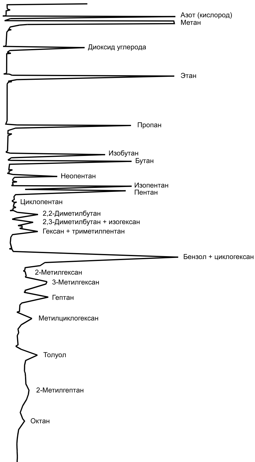
Рисунок А.2 — Типичная хроматограмма азота (кислорода), диоксида углерода и углеводородов от C 1 до C 8 на колонке с Porapak R
